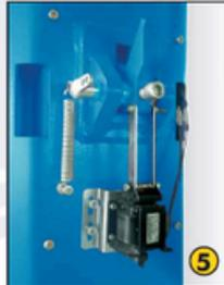
**5.** Sblocco sicuro con elettromagnete 24V
